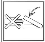
Achtung, Quetschungsgefahr. Erhebliche Verletzungsgefahr. Berühren Sie unter keinen Umständen die gefährlichen Bereiche, solange der Traktormotor läuft und die Kardanwelle, die Hydraulikanlage oder das Elektroniksystem in Betrieb sind.
