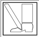
Beim Absenken Abstand zur Maschine halten. Erhebliche Verletzungsgefahr. Darauf achten, dass sich niemand im Absenkbereich der Maschine befindet.
