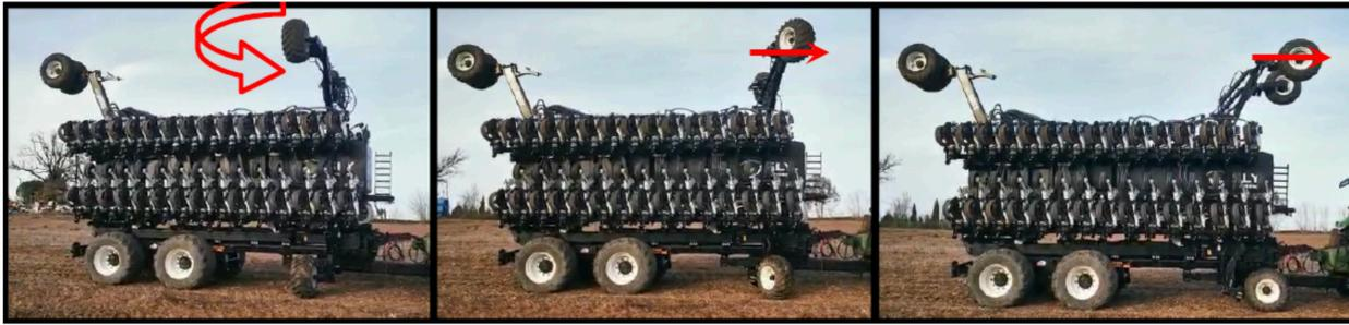
9. Alzare la leva 2 per chiudere il lift assist e le ruote di livello laterali.
