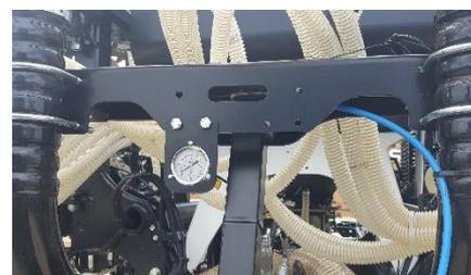
Per modificare la pressione ruotare la manopola di regolazione con una chiave esagonale; ruotarla in senso orario per aumentare la pressione e in senso antiorario per diminuire la pressione.
