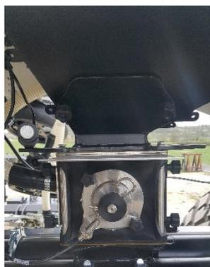
4. Azionare eventualmente il dosatore in funzionamento forzato per scaricare completamente il fondo della tramoggia.
