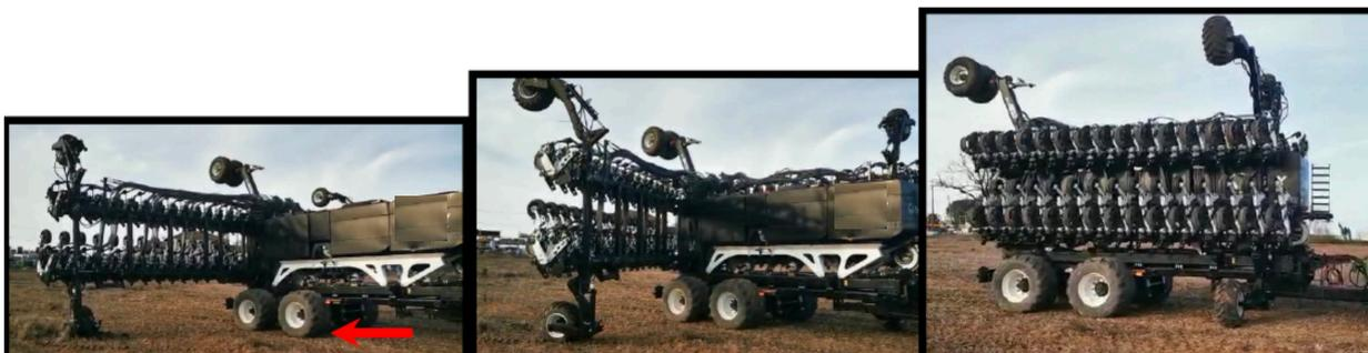
7. Azionare i martinetti del telaio sul trattore per finire di sollevare il telaio e poter bloccare le ali alla fine della chiusura.
