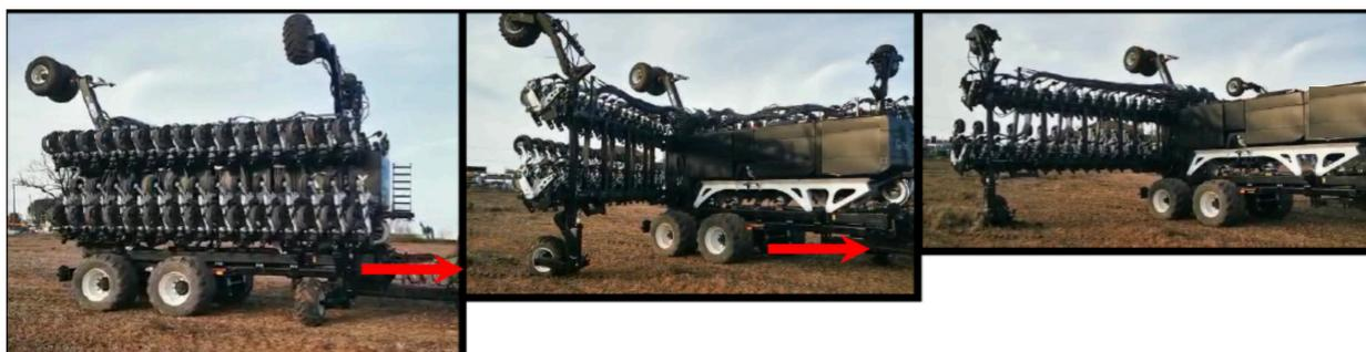
8. Azionare i martinetti del telaio del trattore per abbassare completamente il telaio.
