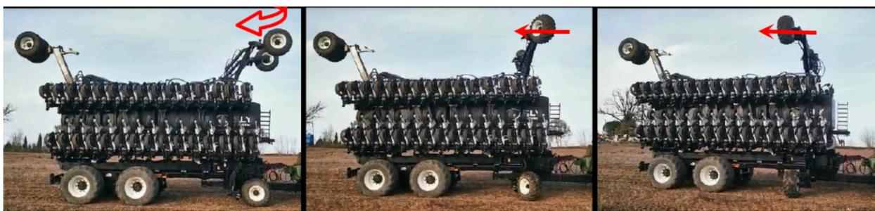
5. Azionare leggermente i martinetti del telaio sul trattore per far uscire le ali dal sistema di blocco.
