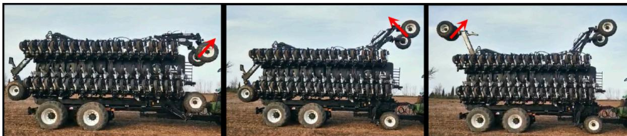
4. Alzare la leva 4 per aprire le ruote di livello laterali.
