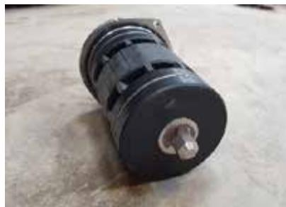
Enlever le circlip maintenant les différents rotors sur l'axe hexagonal à l'aide d'un marteau et d'un chasse goupille.
