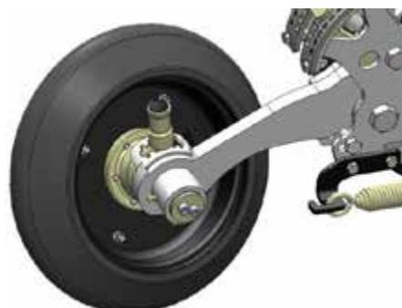
Tirer la manette de réglage au niveau de la roue de rappui et la positionner sur le cran souhaité.
