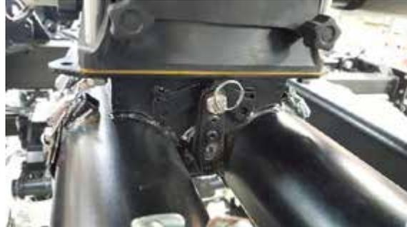
Pour envoyer le contenu de la trémie dans l'ensemble du semoir le levier doit être sur la position du milieu, pour choisir une seule des deux rangées. Positionner le levier sur la rangée correspondante. Répéter cette action sur l'ensemble des doseurs.
