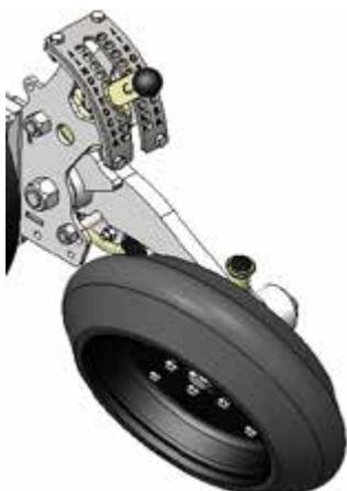
Tirer la manette et la positionner sur le cran souhaité grâce à la plaque de réglage graduée.
