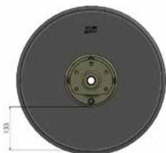
Un disque neuf d'élément Boss a un diamètre de 18" (soit environ 457 mm). Celui-ci est équipé d'un biseau facilitant la pénétration dans le sol et la découpe des débris végétaux (paille) et des couverts vivants, limitant de ce fait fortement le phénomène de pinçage de pailles dans la ligne de semis néfaste pour le semis.
