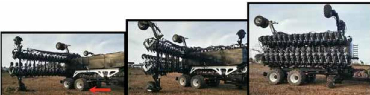
7. Actionner les vérins du cadre sur le tracteur pour terminer de lever le cadre et pouvoir verrouiller les ailes à la fin du repliage.
