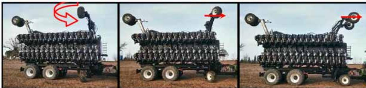
9. Relever le bouton 2 pour replier le lift assist et les roues de jauge latérales.
