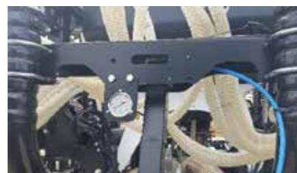
Pour modifier la pression tourner la molette de réglage à l'aide d'une clef Allen dans le sens des aiguilles d'une montre pour augmenter la pression et dans le sens inverse pour la diminuer.
