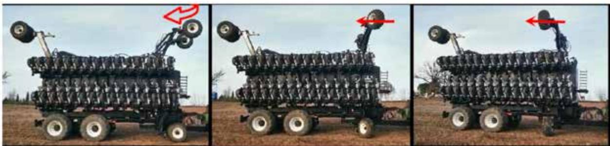
5. Actionner légèrement les vérins du cadre sur le tracteur pour faire sortir les ailes du système de verrouillage.
