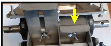
Pour utiliser uniquement les petites cannelures, fermer la trappe coté droit de la distribution. cela évitera de désaccoupler les 2 grosses cannelures.
