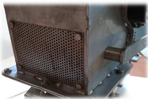
Pour modifier le positionnement des cuillères, il faut commencer par enlever la grille de protection des vis de réglage des cuillères situées à l'arrière de la distribution.
