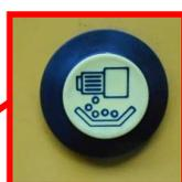
3- Appuyer sur le bouton « test » et le tenir en pression pour faire fonctionner le moteur de la distribution. Relâcher le bouton lorsque le sac est rempli.
