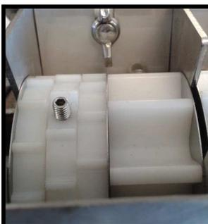
Utiliser une clé à laine de 3 pour désaccoupler les petites cannelures en fonction de la quantité souhaité. Ne pas dévisser complètement. La tête de la vis doit venir en butée contre la trappe pour bloquer la cannelure.
