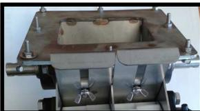
Pour utiliser uniquement les petites cannelures, les 2 trappes doivent être ouvertes.
