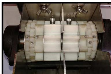
Utiliser une clé à laine de 5 pour désaccoupler les 2 grosses cannelures de la distribution. Ne pas dévisser complètement. La tête de la vis doit venir en butée contre la trappe pour bloquer la cannelure.
