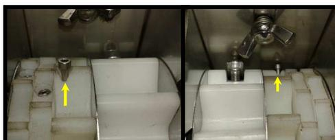
Utiliser une clé à laine de 2,5 pour désaccoupler les 2 moyennes cannelures. Ne pas dévisser complètement. La tête de la vis doit venir en butée contre la trappe pour bloquer la cannelure.
