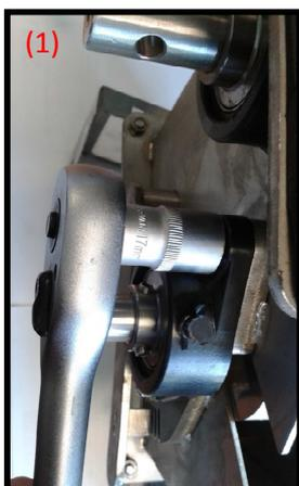
Pour changer les cannelures, il faut commencer par dévisser les vis des paliers (1) puis retirer le train de cannelure de la distribution (2). Poser le train de cannelure (3) sur une surface plane afin de faciliter le changement des cannelures.
