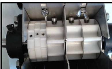
Utiliser une clé à laine de 5 pour désaccoupler la grosse cannelure coté gauche de la distribution. Ne pas dévisser complètement. La tête de la vis doit venir en butée contre la trappe pour bloquer la cannelure.
