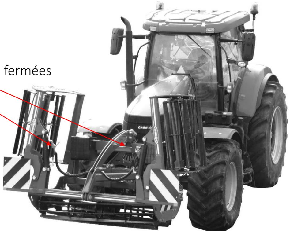
Assurez-vous simplement que les vérins arrivent en fin de course. La sécurité de l'installation est assurée par les vannes  $\frac{1}{4}$  de tour sur les vérins. Respectez les précautions décrites dans le chapitre 4.2 Connexions hydrauliques.
