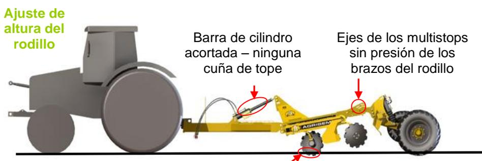
Primera hilera de los discos en el suelo = desplazamiento del centro de gravedad hacia delante
